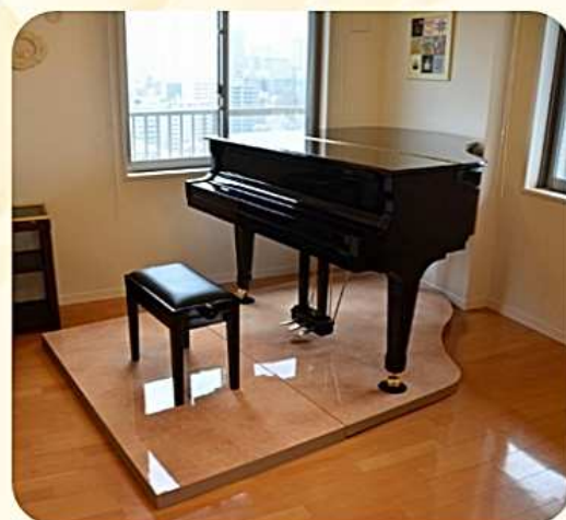
階下へ個体振動音を伝えないピアノ架台
